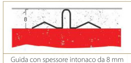
Guida con spessore intonaco da 8 mm
