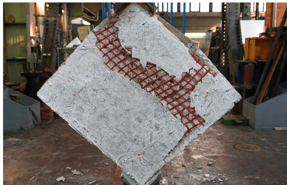
Prove di compressione diagonale
